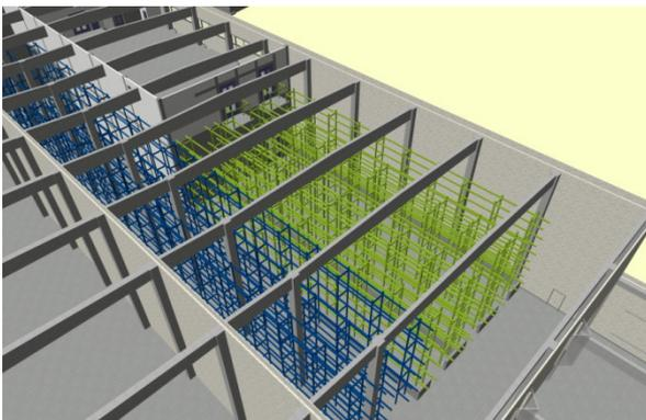
Einbau Rohstofflager in vorh. Hochregallager
