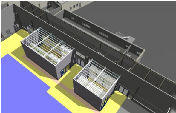
Einbau Halbfabrikatelager in vorh. Produktionshalle
